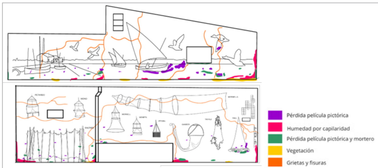
Figura 2-3.- Diagramas de daños del conjunto mural Port de Catarroja antes de la DANA
