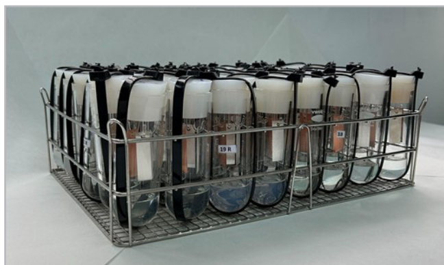
Figura 1. Dispositivo experimental del test de Oddy (plata esterlina, plata y cobre) con los diferentes productos de limpieza a evaluar (ver Tabla 1).
