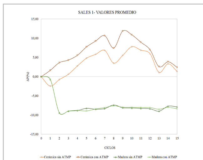
Figura 5.- Resultados de los ensayos de cristalización de sales (Sales 1): comparación de valores promedio de cambio de peso de ambos materiales a lo largo del ensayo, con y sin aditivo ATMP. Fuente: elaboración propia.
