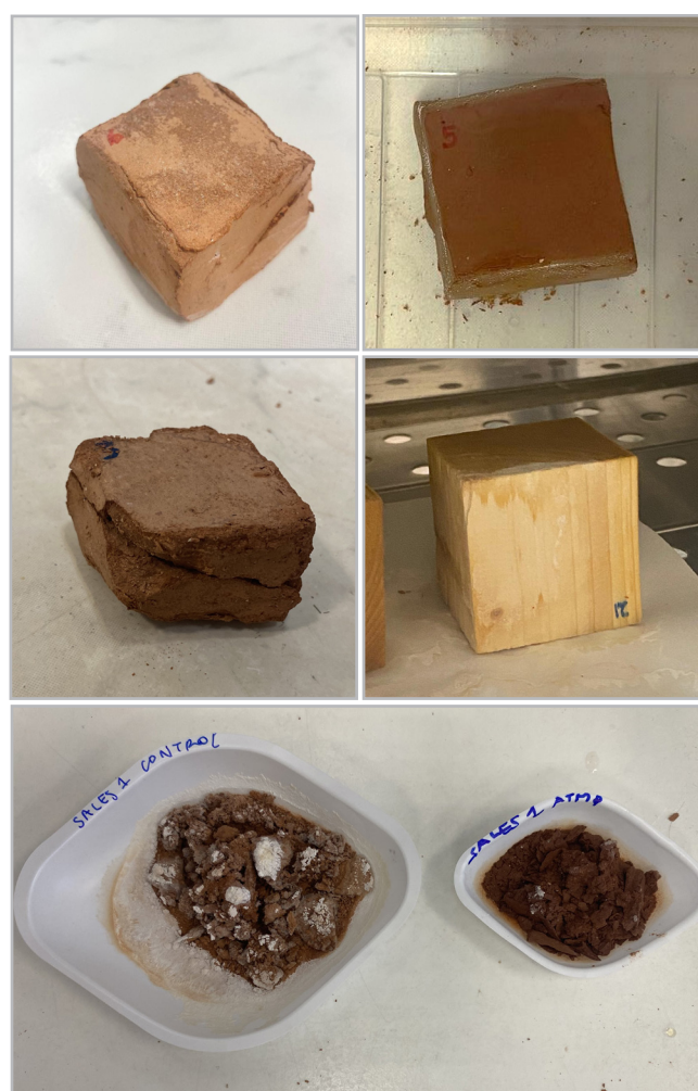
Figura 6.1.- Estado de conservación de las probetas durante y después del ensayo SALES 1: A) De izquierda a derecha y de arriba hacia abajo: erosión superficial de probeta cerámica con aditivo; disgregación de arista de probeta cerámica con aditivo; fracturación y disgregación de esquinas de probeta cerámica sin aditivo; y oscurecimiento heterogéneo de probeta de madera con aditivo; y B) De izquierda a derecha: fragmentos desprendidos de las probetas cerámicas durante el ensayo de SALES 1, de aquellas sumergidas en la solución salina con y sin ATMP, tras 24 horas de secado al aire libre y la cristalización de sales sobre ellos. Fotografías propias.
