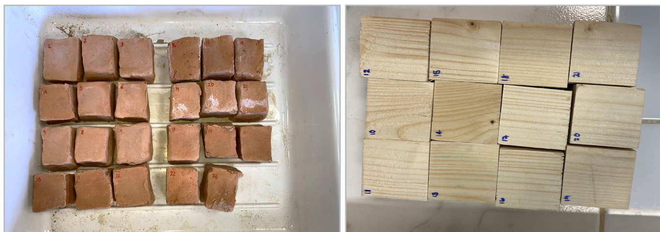
Figura 2.1.- De izquierda a derecha: Probetas de cerámica preparadas a partir de la mezcla procedente de Jun (Granada) empleada en la tesis doctoral de la Dra. Laura Crespo-López López (2024, UGR), ya que su composición era la más afín a la de la cerámica de uso del yacimiento, caracterizada en 2009 por García y Valiente; y probetas de madera de pino, la especie de madera más comúnmente empleada en España y a la que se recurrió ante la falta de información acerca de la conservada in situ .
