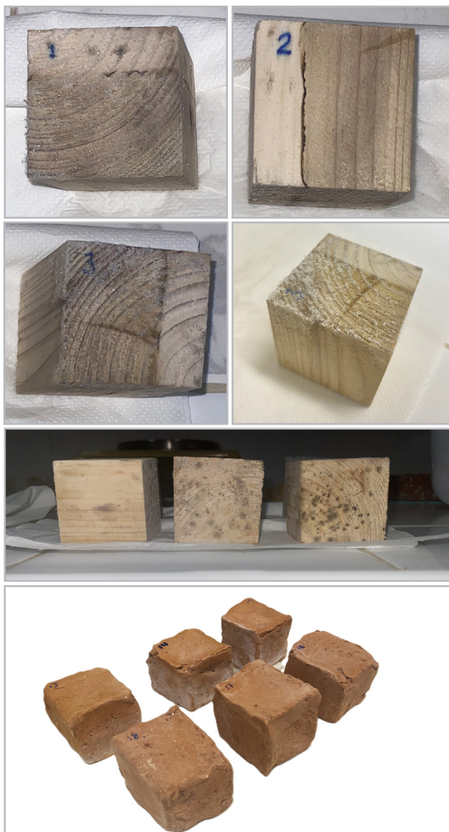
Figura 6.1.- Estado de conservación de las probetas durante y después del ensayo SALES 2: A) De izquierda a derecha y de arriba hacia abajo: oscurecimiento de probeta de madera sin aditivo; oscurecimiento e inicio de fracturación de probeta de madera sin aditivo; oscurecimiento de probeta de madera sin aditivo; y formación de eflorescencia salina en los anillos de crecimiento de la probeta de madera sin aditivo; y B) De arriba hacia abajo: probetas de madera con aditivo y en las que se produjo colonización biológica (no se estableció relación entre ambos hechos); y aspecto final de las seis probetas cerámicas empleadas en este ensayo, correspondiéndose las tres más alejadas con el grupo con aditivo y las tres más cercanas con el grupo sin aditivo. Fotografías propias.
