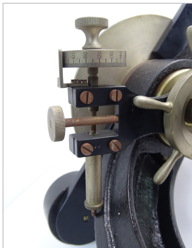
Figura 7.- Detalle de tornillos oxidados en un refractómetro total del s.XIX. Museo Geominero (N052). Fotografía: S.Bartolomé
